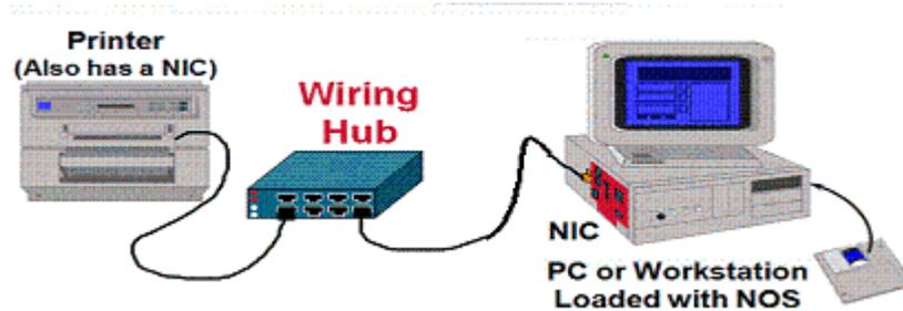
Fig. 4.1.3 Wiring Hub
